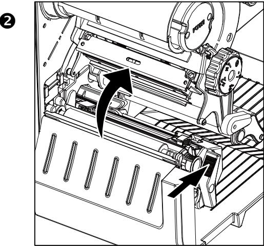
**Loading Media/安装標籤/安装标签/メディアの読み込み/Загрузка носителя/ Medien werden geladen/Chargement des medias/Cargando medios/Caricamento dei media/تحميل الوسائط**
