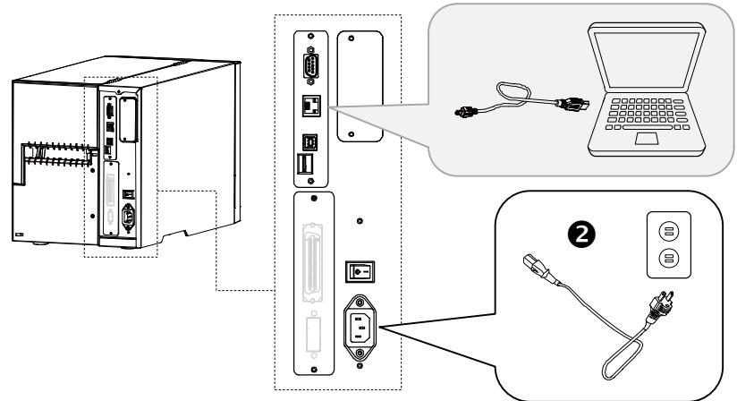
Turn on the Power/開啟電源/开启电源/電源を入れる/Включение принтера/Schalte den Strom an/Allumer l'appareil/Conectar la alimentación/Accendi il potere/تشغيل الطاقة
