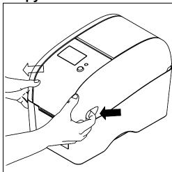
(1) Откройте верхнюю крышку принтера, потянув защелки с каждой стороны на себя. Поднимите крышку до упора.
