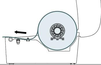
(7) Используйте "Diagnostic Tool" для установки типа датчика носителя и калибровки выбранного датчика. to set the media sensor type and calibrate the selected sensor. (Запустите средства диагностики "Diagnostic tool" → Выберите закладку "Printer Configuration" → Нажмите на клавишу "Calibrate Sensor")
