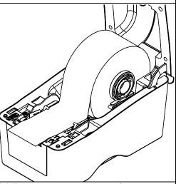
(4) Пропустите этикетку рабочей стороной вверх через направляющие и датчик носителя. Протяните передний край этикеток так, чтобы часть ее осталась на резиновом вале.
