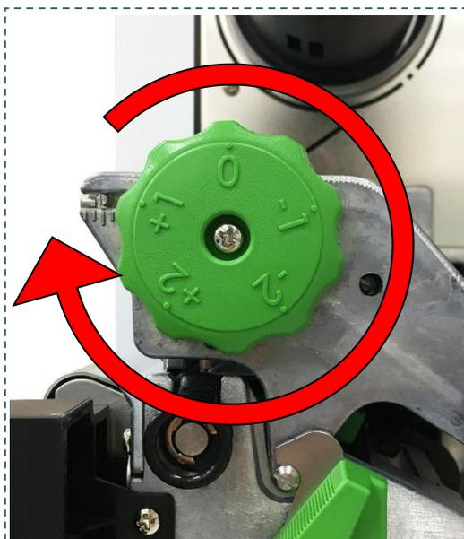
Рукоятка для регулировки прижима печатающей головки позволяет устанавливать один из 5 уровней прижима. Поскольку бумага в принтере выравнивается по левой стороне механизма, для правильной печати на носителях разной ширины требуется разное давление. Поэтому для достижения наивысшего качества печати может понадобиться отрегулировать прижим рукоятками для регулировки прижима.
