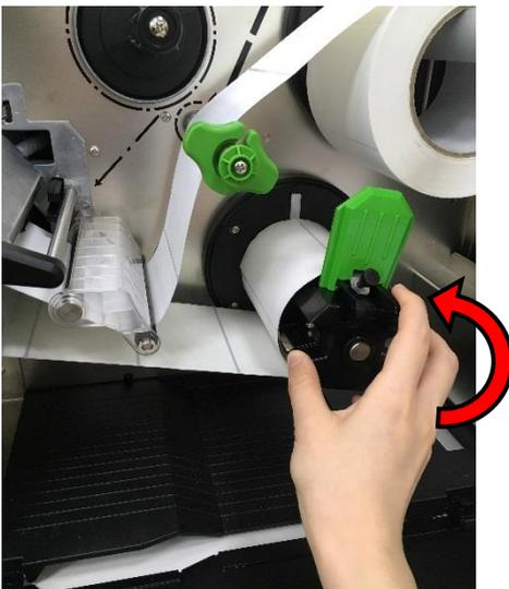
8. Намотайте этикетку на внутренний вал обратной перемотки и приклейте этикетку к бумажному сердечнику. Вращайте вал против часовой стрелки до надлежащего натяжения носителя.
