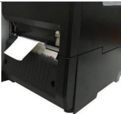
8. Закройте рычаг фиксатора печатающей головки и, используя дисплей на лицевой панели, задайте настройки принтера для режима снятия защитной пленки.
