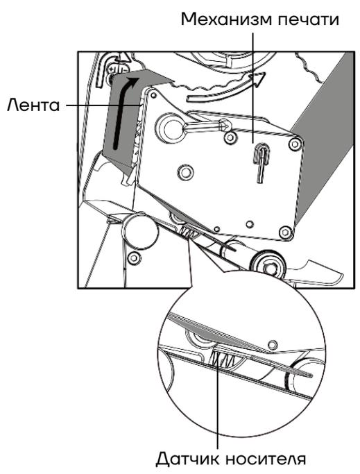
**4** Пропустить ленту через печатающий механизм и вал приема ленты, затем обернуть ее 2-3 раза вокруг вала приема ленты.
