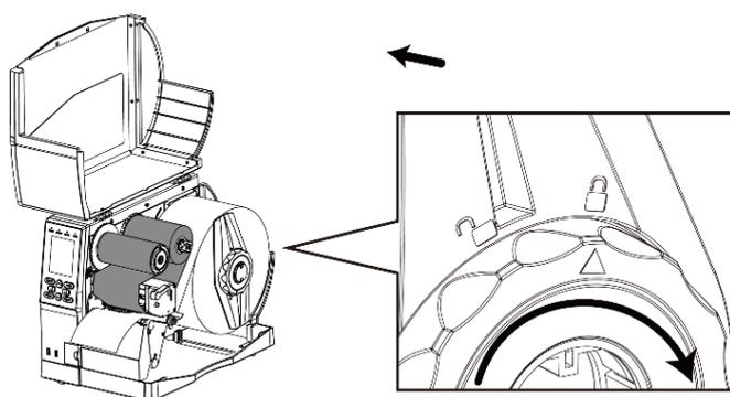
**2** Установить рулон этикеток на вал носителя. Убедиться, что рулон установлен до упора и расположен параллельно внутренней стенке принтера. После загрузки рулона этикеток установить направляющую носителя на вал носителя. Затем повернуть фиксатор так, чтобы указатель был в положении «Заблокировано», фиксируя направляющую.
