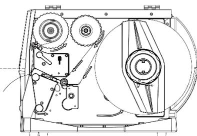
**5** Загрузив этикетку, опустите рычаг печатающей головки так, чтобы лента оказалась плотно прижатой к этикетке.
