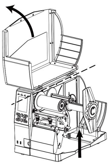
**2** Установить ленту внешним красящим слоем на вал подачи ленты и повернуть фиксатор против часовой стрелки до упора для фиксации ленты.
