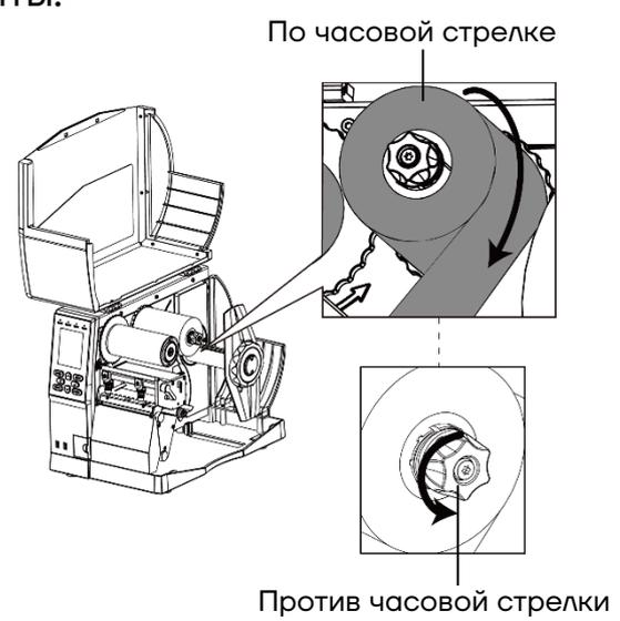
**3** Вытянуть небольшую часть ленты, пропустить ее между механизмом печати и датчиком носителя.
